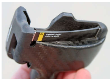
Obrázek 10: Keo Blade Aero pedál s plochou pružinou z karbonových vláken
