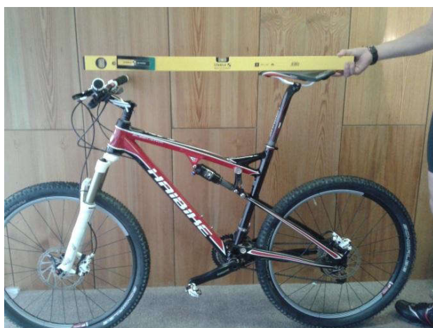
Obrázek 8: Nastavení řídítek a sedla
